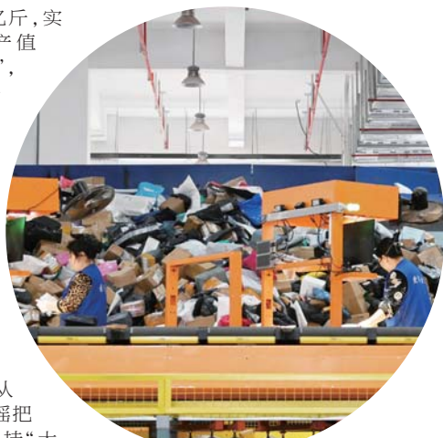
堆积如山的包裹通过扫码后进入自动分拣传送装置。
