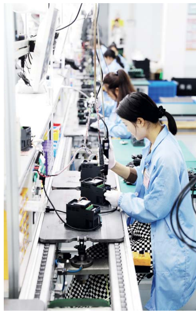
↑萧县安徽海尚变频技术有限公司的生产线上，女工们正在组装变频器。
