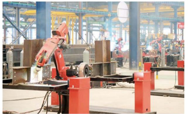
金寨鸿路钢结构绿色建筑制造基地生产线上，机器人在进行零部件焊接。
